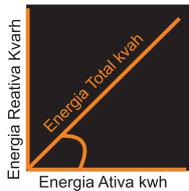
A segunda, a energia ativa, medida em kWh, é a que realmente produz as tarefas, isto é, faz os motores e os transformadores funcionarem. A composição destas duas formas de energia resulta na energia aparente ou total.
